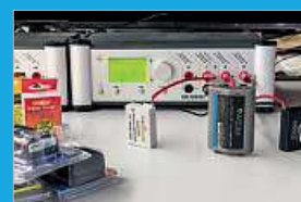
Im Labor: Mit zwei Voltcraft Akkuladestationen ALC 8500 können wir bis zu acht Akkus gleichzeitig messen.
